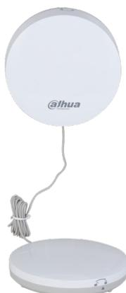
Rilevatore di liquidi (sensore separato) wireless IPX5, indicatore di stato luminoso, 1 tasto, update remoto tramite cloud, potenza segnale, segnalazione batteria scarica (verificabile anche su app), frequenza portante 868~868.6 MHz, comunicazione bidirezionale, crittografia AES128, salto di frequenza, batteria CR123A (durata 3 anni)
