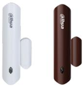
Sensore contatto magnetico porta/finestra wireless (small), range rilevamento <40 mm, 1 indicatore di stato luminoso, allarme antimanomissione, allarme tapparella, segnalazione batteria scarica, frequenza portante 868~868.6 / 433.1~434.6 MHz, contatto reed, crittografia AES128, batteria CR123A <125 mW (durata 5 anni)
