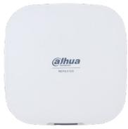
Ripetitore wireless, 32 periferiche collegabili (associazione automatica/manuale), 1 indicatore luminoso, 1 tasto accensione, allarme antimanomissione, update remoto tramite cloud, potenza segnale, segnalazione batteria scarica, frequenza portante 868~868.6 / 433.1~434.6 MHz, comunicazione bidirezionale, crittografia AES128, salto di frequenza, alimentazione 12 Vdc, batteria ausiliaria al litio
