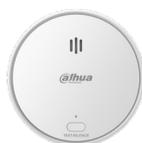
Rilevatore di fumo wireless da interno, sensore fotoelettrico, indicatore LED luminoso, allarme fumo, guasto, segnalazione batteria scarica (volume 85~90 dB(A) a 3 m), area copertura 20~40 m<sup>2</sup>, tasto test/silenzioso, comunicazione bidirezionale, frequenza portante 868~868.6 / 433.1~434.6 MHz, crittografia AES128, salto di frequenza, 3 batterie CR123A (durata 3 anni), certificazione EN 14604:2005, AC:2008
